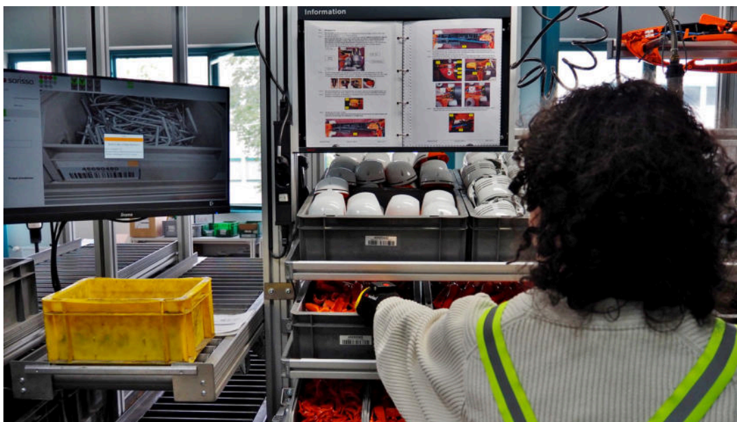
Über Sensorikhandschuhe wird der aktuelle Arbeitsschritt verfolgt und via Bildschirm oder Laser der nächste Prozessschritt angezeigt. (© IWU)
